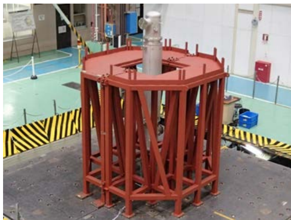
図11: 水平二方向・鉛直方向の三方向同時加振が可能な三次元振動台。
