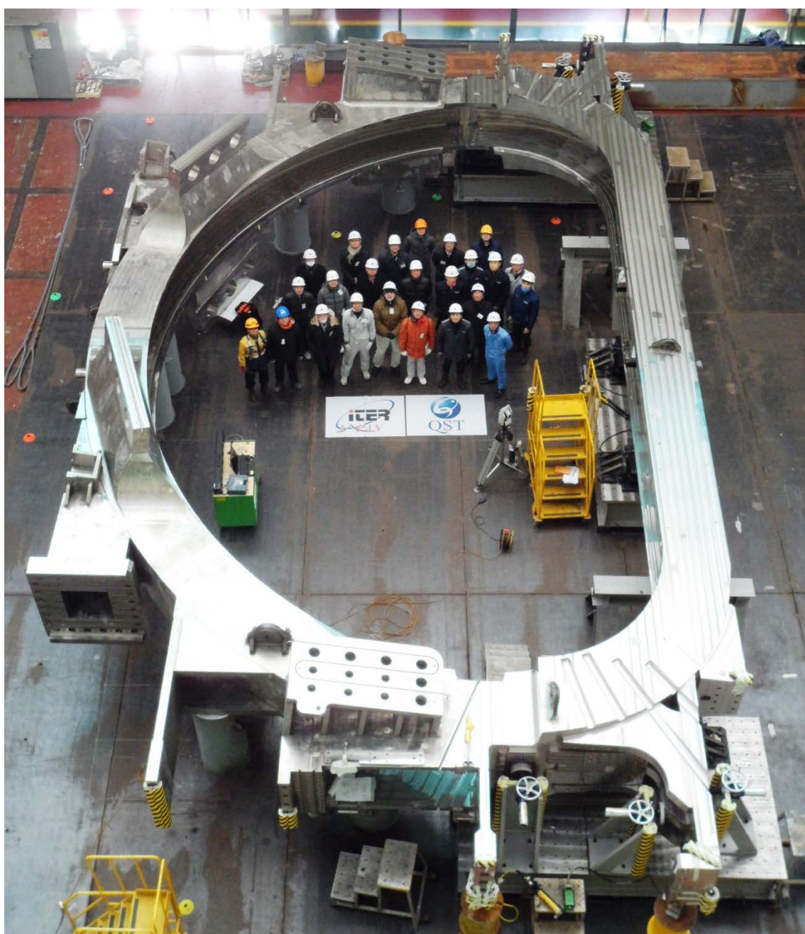
図3: AU-BU仮組試験に合格した欧州向け第1号機TFコイル容器と関係者一同
