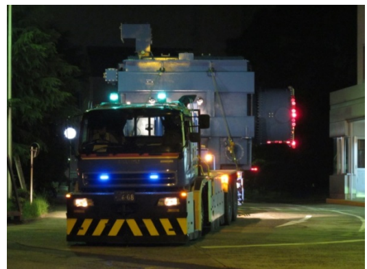
図8: 1MV絶縁変圧器の輸送
