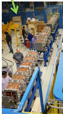
レニャーロ研(伊)で3基のRFQスーパーモジュールの組立が完了。2016年初旬に六ヶ所に設置予定(5MeV, 125mA, 定常)
