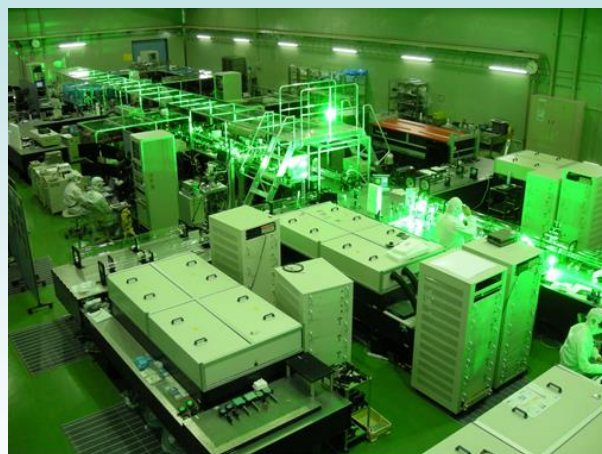
関西光科学研究所に設置されている 超高強度レーザーシステム
