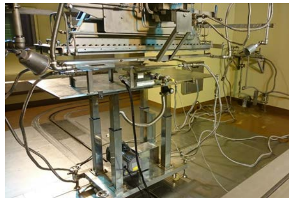
図 1 高温電子線照射装置
