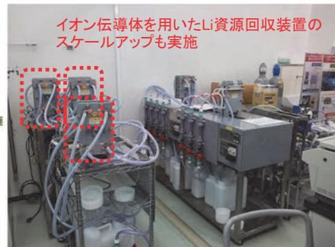
イオン伝導体を用いたLi資源回収装置の
