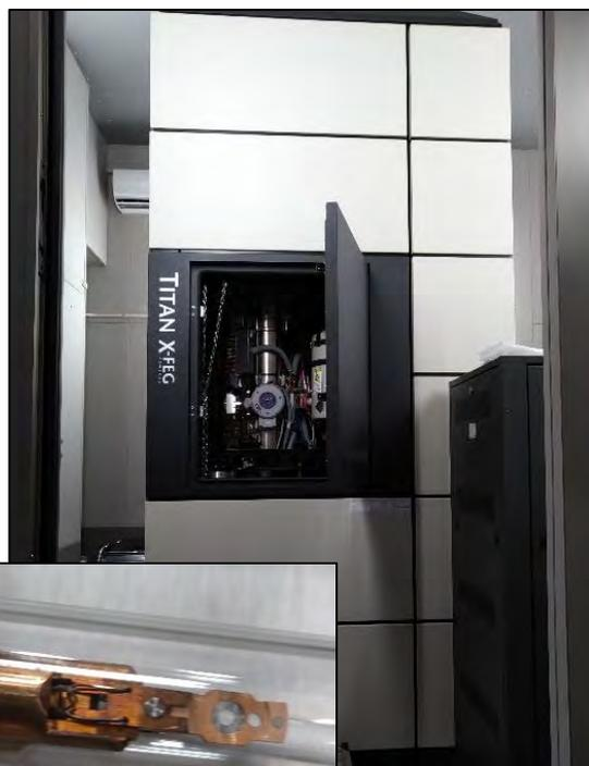
一般的なTEMでは一方向から目的の試料の投影像を観測する事になりますが、このTITANと高度三軸ホルダー[図2](通称:波多ホルダー)を利用する事により、電子線を照射しながら試料を回転させる事で、様々な方向から試料を観測する事ができます。また測定された各二次元データを適切に解析処理することで三次元像の再構成が可能となります。研修では持参した100~300nmサイズのBaTiO<sub>3</sub>ナノ結晶試料を測定しました。現在この試料は放射光のコヒーレントなX線を利用した三次元構造解析も行っており、両者での見え方の違い等をモチベーションとして研修に参加させていただきました。
