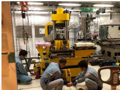
図1 業者による実験ハッチ1からの搬出
