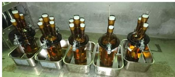
図4 腐食試験セル
