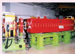
④ 主加速器偏转电磁铁
