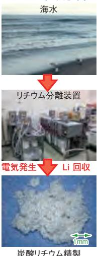
イオン伝導体をリチウム分離膜とし、海水中に無尽蔵に含まれている、核融合燃料(三重水素)製造に必要なりチウムを、効率的に回収します。
