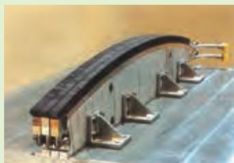
耐熱タイルの実規模試験体
