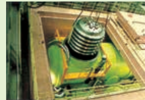
中性粒子ビーム入射加熱装置 高いエネルギーを持った水素負イオンビームを発生するMeV級イオン源試験装置
