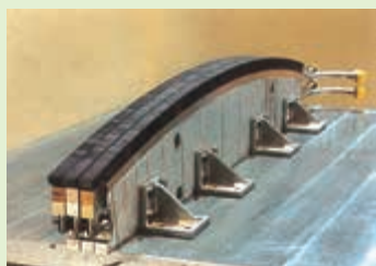
耐熱タイルの実規模試験体(全長:約1.3m)
