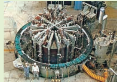
13テスラ発生に成功したITER用超伝導モデル・コイル(外径3.6m)
