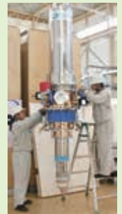
高周波加熱装置 ジャイロトロンと呼ばれる大電力ミリ波の発振管
