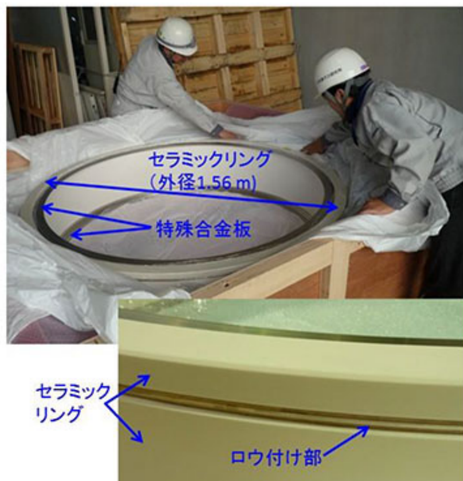
図3: 特殊合金板とロウ付けした大口徑セラミックリング
