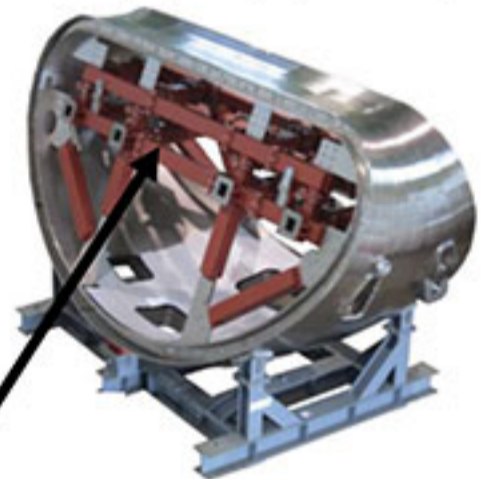
図7: 真空容器40度セクターの拘束治具
