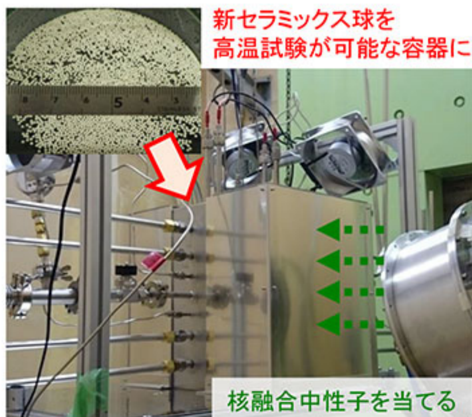
図9: 新たなリチウム含有セラミックス球のトリチウム放出特性評価
