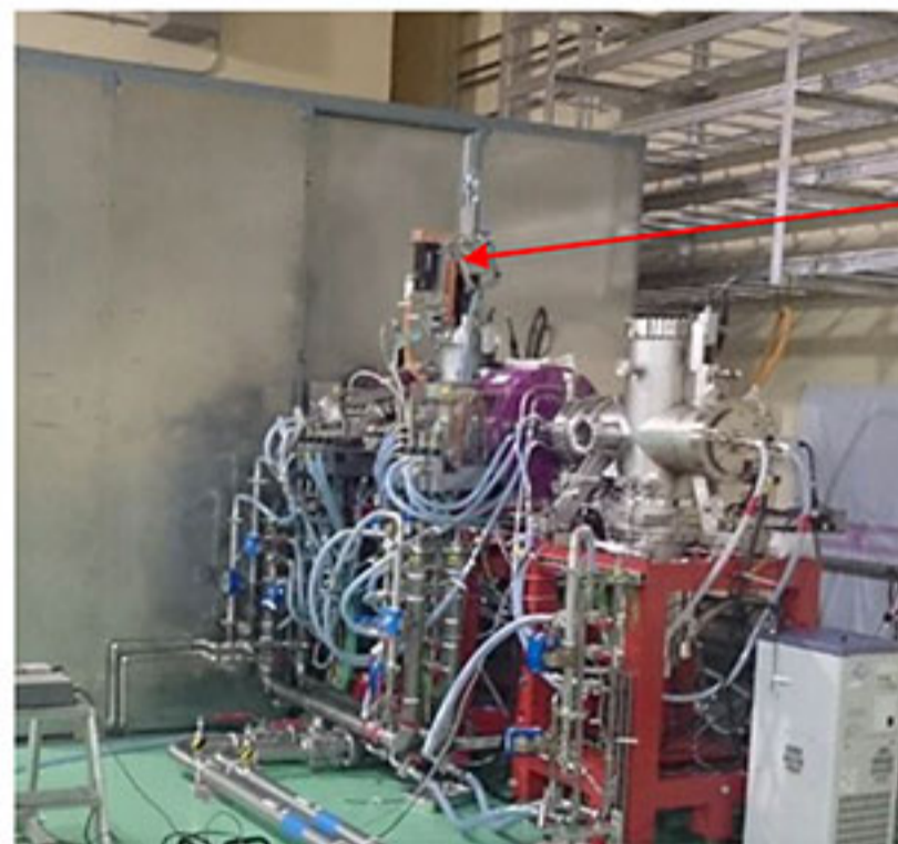
図15:水素ビーム試験を開始したIFMIF原型加速器の入射器
