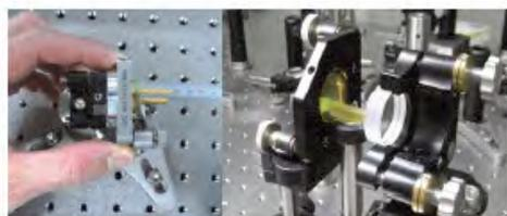
指先ほどの大きさのマイクロチップレーザーと光パラメトリック発振器を組み合わせることにより初めて小型化と高出力化に成功。
