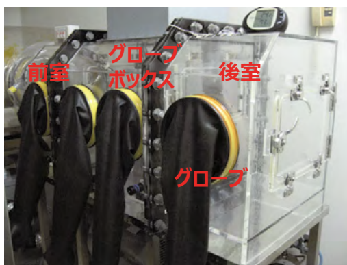
搬出入接続装置
