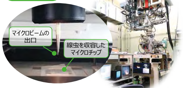
イオンマイクロビーム照射装置（右）を用いた線虫へのマイクロビーム局部照射。マイクロチップの厚さをイオンビームが透過可能な1mm以下としたことで、ヒットしたイオンの正確な検出と照射後の線虫の観察を実現。
