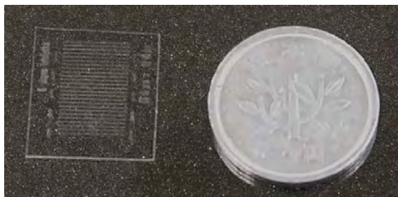
厚さ300 \mu\text{m} の線虫収容保定用PDMSマイクロチップ（左）。
