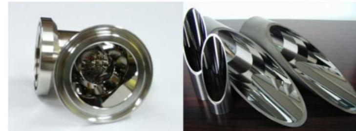
(b) SUS304の電解複合研磨の事例
