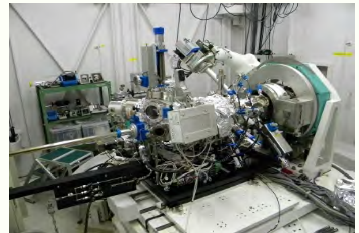
図1 大型放射光施設SPring-8の量研機構専用ビームラインBL11XUに設置されている分子線エピタキシー(MBE)装置が搭載されている表面X線回折計の写真(放射光科学研究センター コヒーレントX線利用研究グループ)
