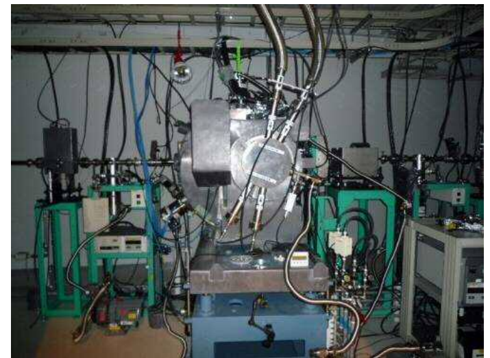
大型放射光施設SPring-8の量研ビームラインBL11XUの放射光輸送部(上)と二結晶分光器(下)
