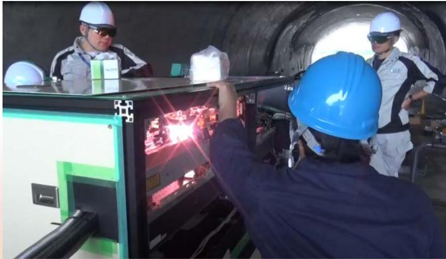
図1:レーザーシステムのメンテナンス作業
