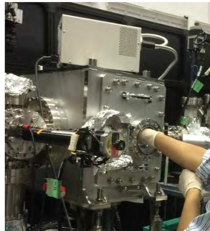
写真2: 実験装置に試料を設置している様子。レーザー照射は真空中で行います。
