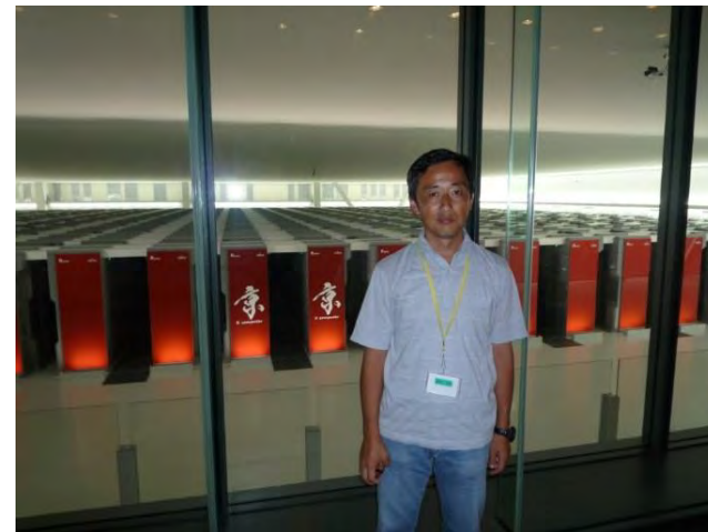
図1. 私が見学に行ったときに撮影した京コンピューター。多くのCPUを収納した赤色のラックが、50m四方の部屋にたくさん並んでいます。
