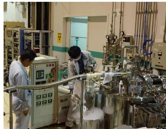
BL11XUの分光結晶を冷却するための液体窒素循環装置を立ち上げる甲斐(左)と菅原
