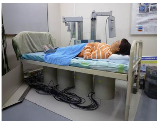
図 1：ホールボディカウンタでの測定の様子 (ベッドの下に 4 つ見えるものが NaI(Tl) シンチレーション検出器)
