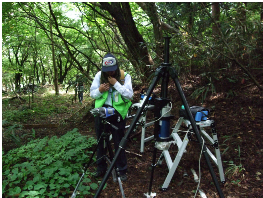
図 2－2．山林内での放射線波高分布の測定風景
