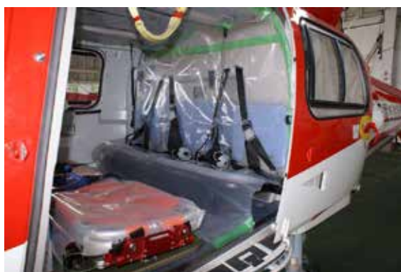
図 22. ヘリコプター壁の養生
