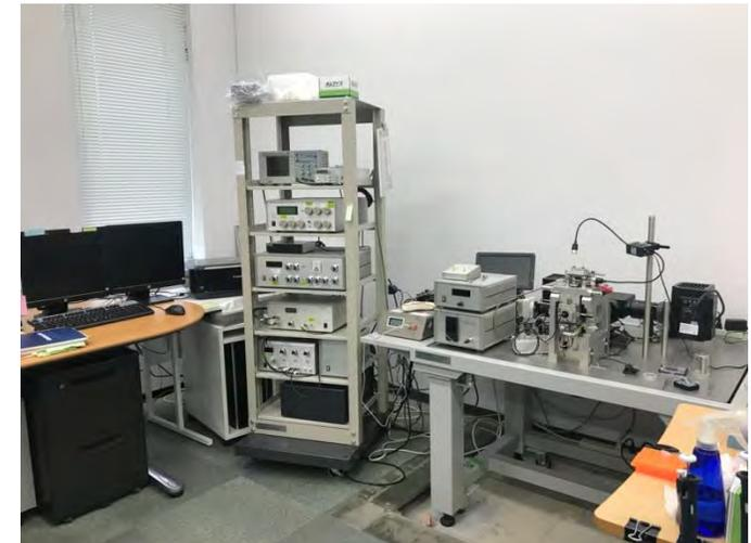
図1 原子間力顕微鏡
