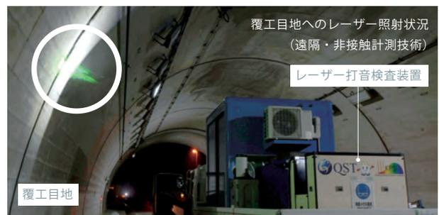
コンクリートの壁面をレーザーで叩き、その振動をレーザーで検出することで検査を行います。道路トンネルで行うためにトラックの荷台に積載しても安定に動作するレーザーシステムを開発しました。
