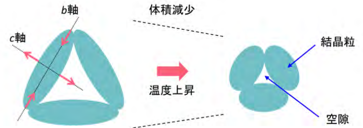
図2 結晶粒の異方的な熱膨張による材料組織の変化と負熱膨張の模式図。材料組織を形成する針状の結晶粒は、長手方向がb軸に対応しています。昇温による格子変形に伴って太鼓型に変形し、それによって結晶粒間の空隙が減少するために、全体として体積が大きく収縮します。
