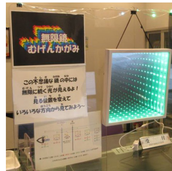
無限鏡(LEDテープライト、鏡、ハーフミラーで作る光のトンネル)
