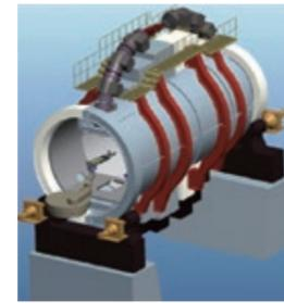
円筒構造体に取り付けられた超伝導電磁石により高エネルギー炭素ビームが患者まで輸送される。構造体が0度から360度回転することで、患者へ任意の角度から照射することが可能となる。
