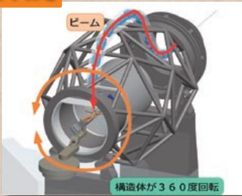
回転ガントリーとは照射ノズルや粒子線を輸送するための電磁石群を備えた装置であり、装置が患者さんを中心に360度回転することで任意方向から粒子線を照射することが可能となります。患者さんを傾ける必要がなくなることから身体的負担を軽減できること、また傾けることによる臓器移動がないため照射精度が向上するなど、多くの利点があります。更に治療計画の自由度が増すことから重要臓器への線量抑制が可能となるなど、より高度な治療照射が可能となります。陽子線では1990年に米国ロマリンダ大学の陽子線治療施設で採用され、これを皮切りに国内外での研究開発が盛んになり、今では標準的に採用されるまでに至っています。一方、重粒子線用回転ガントリーに関しては世界で唯一、独逸ハイデルベルグ大学に建設されたのみで、普及が進んでいませんでした。これは重粒子(炭素)が陽子に比べ12倍重く、必要な電磁石や構造体も相当大きくなることから、ガントリー全体の設計・製作が困難であるためです。
