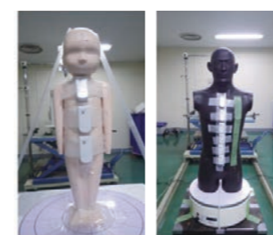
図1: 実験に用いた人体形状ファントム 左から0歳児、成人の体格を模擬。体幹部に個人線量計Cが設置されている状態。
