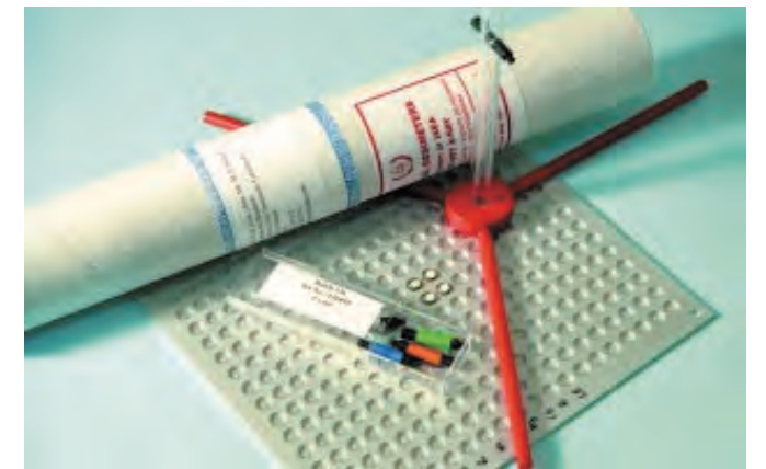
図1: IAEAのTLDと照射ジグ
