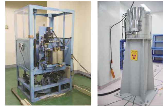
図 4-2: [左] スタンド型 \gamma 線照射装置(三興工業(株)製)と [右] ^{137}\text{Cs} 二方向二線源照射装置(ポニー工業(株)製 PSCD2008 HS)
