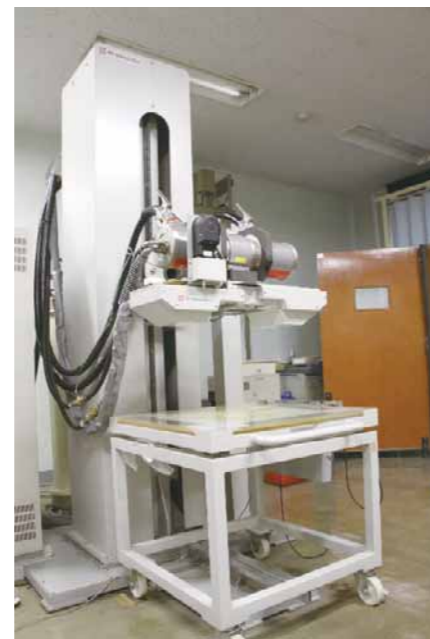
図 4-1: 工業用 X 線照射装置 (株)島津製作所製 PANTAK HF-320S
