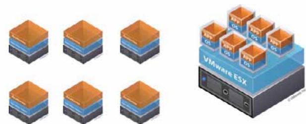
従来: サービスの数だけサーバが必要 仮想化: 1台のサーバで複数のサービスを提供
