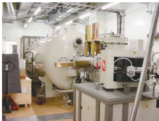
図 3: 中性子発生用加速器システム「NASBEE」の HVEE 社製 Model 4120 HC+タンデトロン加速器 (Coaxial type)
