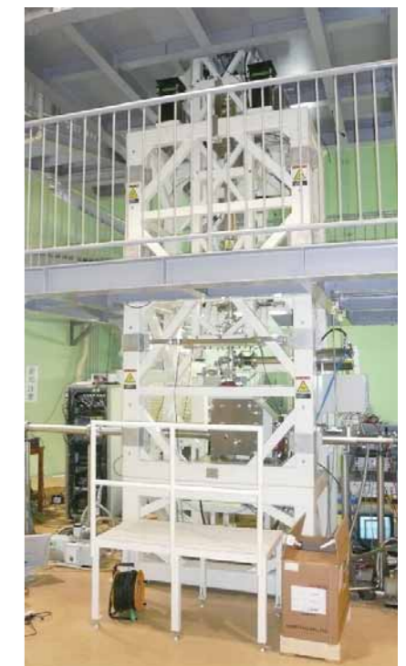
図2: マイクロビーム細胞照射装置(SPICE)のビームライン
