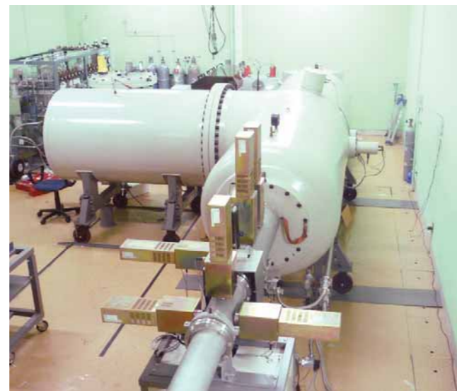
図1-1: 静電加速器棟に設置されているHVEE社製 Model 4117 MC+ タンデトロン加速器(T-shape type)
