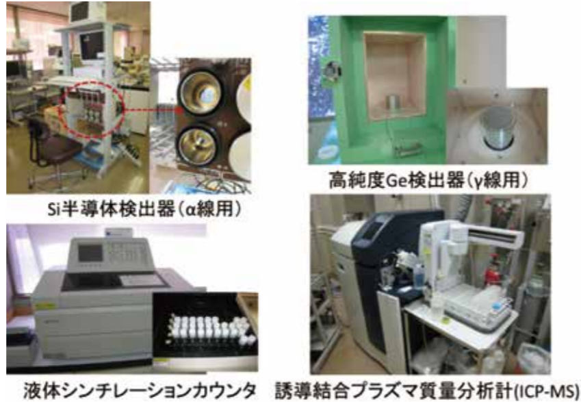
図11: 被ばく医療共同研究施設に設置されている放射性物質測定装置
