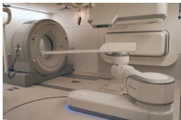
図25: CTシミュレーション室で、搬送台車から治療天板をつかまえている治療台(上図)と、アイソセンタ位置に天板が移動している状態(下図)
