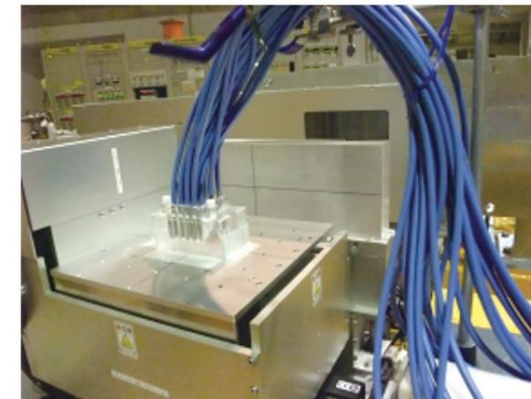
図10:呼吸同期スキャニング照射の試験セットアップ
