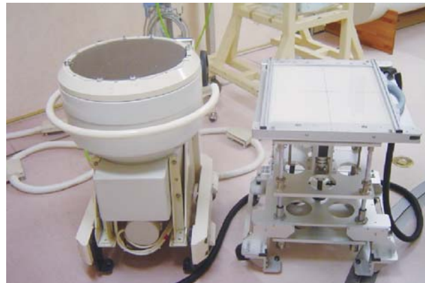
図2: 垂直撮影用台車 (左側が II 管、右側が FPD 用)。 FPD 台車と比較して、II 管台車は見た目以上に重量があり、ケーブルの引き回しと合わせて扱いにくいものでした。
