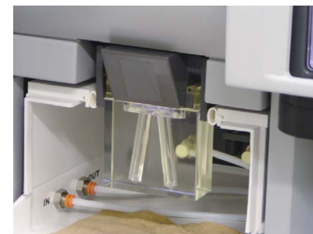
図6: 2Way FolderをFACS Ariaに取り付けた状態。
