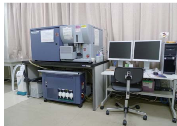
図1: FACS Ariaの外観。右がコントロールPCで左にある白くホースが繋がっているのがAMO。真ん中にある実験台の上の装置がFACS Aria。
