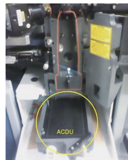
図4: ACDU (Automated Cell Deposition Unit)。スライドまたはマイクロウェルプレートを用いることでチューブ以外にもソーティングすることが出来ます。
