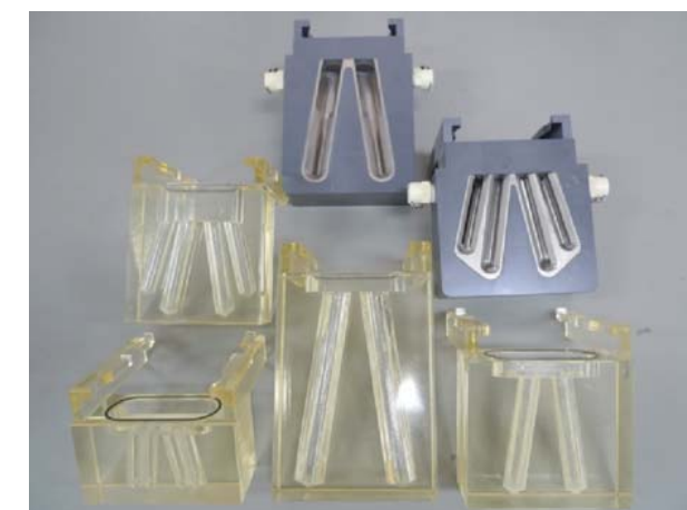
図5: FACS Ariaのソーティングで用いられるTube Folder
