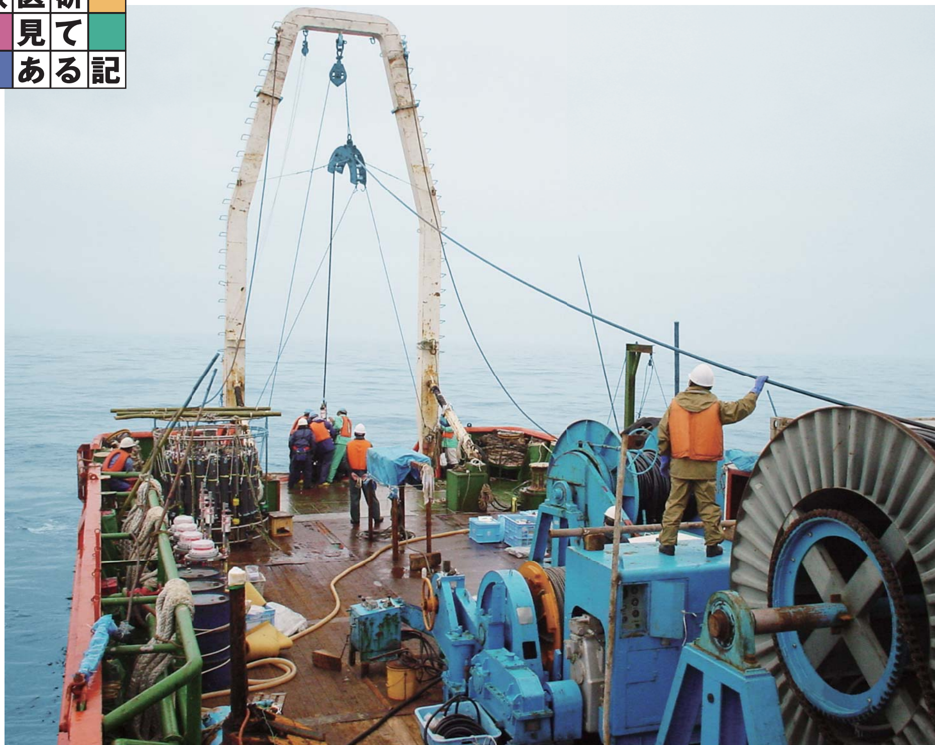
▲太平洋東北沖における海洋観測の様子:現場型大容量海水濾過濃縮装置の取付け作業
