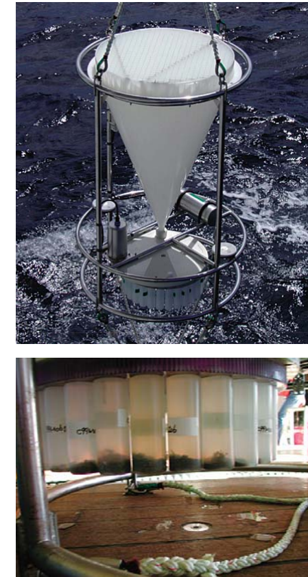
図7:(上)セジメントトラップ(沈降粒子捕集装置)の外観 (下)採取した沈降粒子試料
