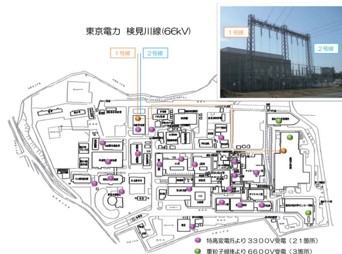
図1: 東京電力からの引込線の位置と放医研内の受変電設備の位置
