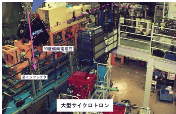
写真5: 大型サイクロトロンに設置されたバックアップイオン源
