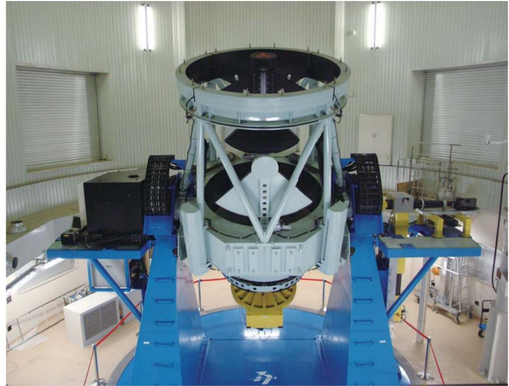
写真2: 日本最大の光学望遠鏡。2m「なゆた」。左側のテーブルに鎮座している黒い箱が可視分光分光器 (MALLS)。
