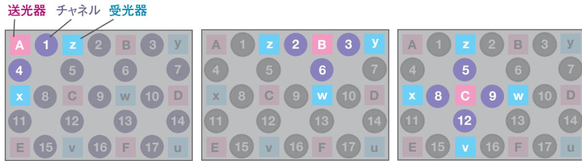
図3: 時間差照射による多チャンネルNIRS計測の原理
