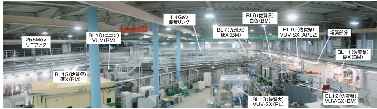
図3: 実験ホール現状。ホール南側テラスから撮影。図中BM、PL、APL2は利用している放射光光源を意味しそれぞれ、偏向電磁石、プラナー型アンジュレータ、APPLE-II型アンジュレータに対応します。
