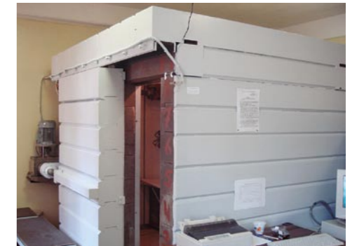
図6. 鉄シールドに囲まれたwhole body counter
