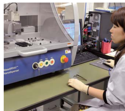
多型解析チップ上にオリゴDNAを微量分注して固定(ゲノム診断)
