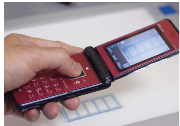
図1:放射線感受性遺伝子多型の解析結果を記録する様子。マイクロアレイスライド上のスポットイメージは携帯電話に付属しているデジタルカメラで撮影することができるため、撮影後にインターネットを経由して遠隔地へ送信することが可能。
