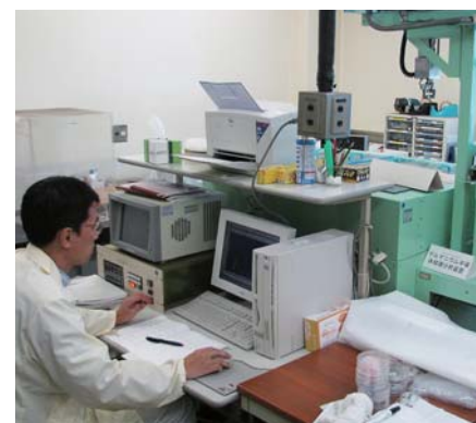
▲海洋試料用Ge半導体核種分析装置 (那珂湊支所)
