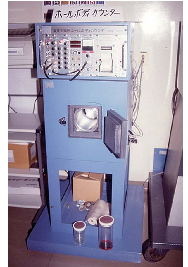
写真2:海産生物の放射線測定装置 (ホールボディカウンター)
