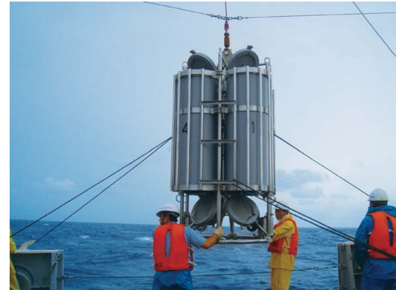
図3: 放射性核種分析用海水試料採取に用いる4筒式大量採水器
