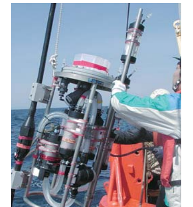
図1: 現場型超大容量濾過濃縮装置 (LV-FiCS)
