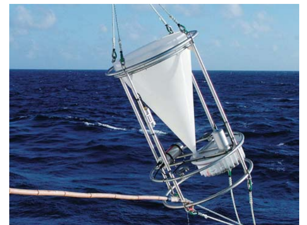
図4: 沈降粒子捕集装置（セジメントトラップ）
