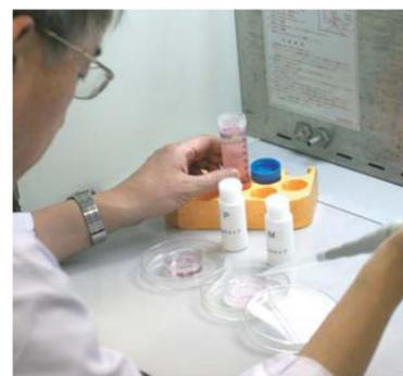
▲ クリーンベンチ内で初代培養したマウスの表皮細胞に培養液を加える実験操作(広部チームリーダー提供;p22-p30)
