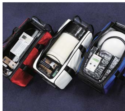
▲航空機内で計算精度の検証に用いる放射線測定装置
