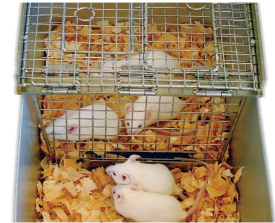
図 2-1-1: 2分割ケージ蓋と飼育ケージ。金網の蓋とケージ内の仕切りが一体となっている。
