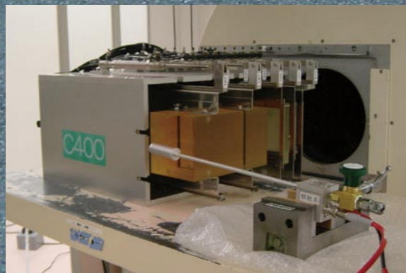
▲ 組織等価比例計数管を用いた炭素線 (HIMAC治療用B室水平コース)の線質測定
